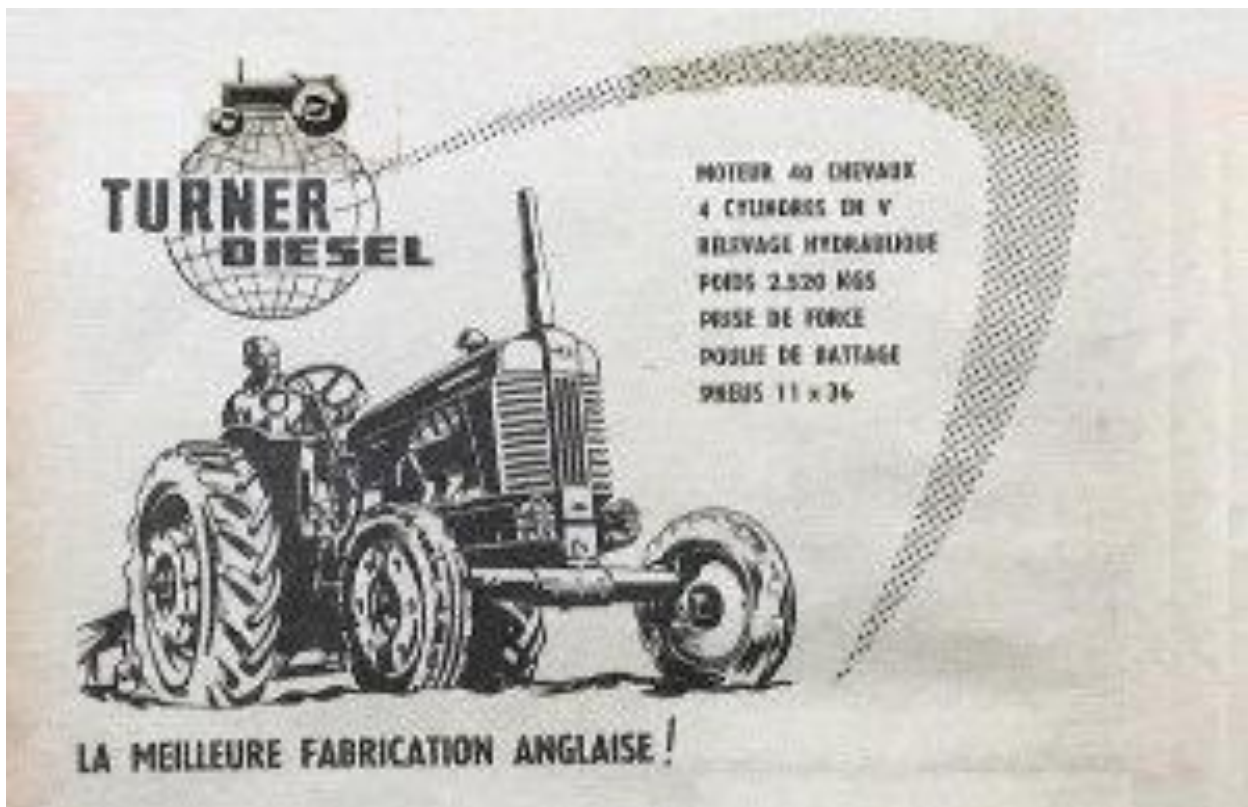
Een advertentie uit een Franse krant. Motor 40 pk 4 cilinder in V, Hydraulische hefinrichting, gewicht 2550 kg, Gunstige prijs, met riemschijf, banden 11 X 36 De beste Engelse productie
