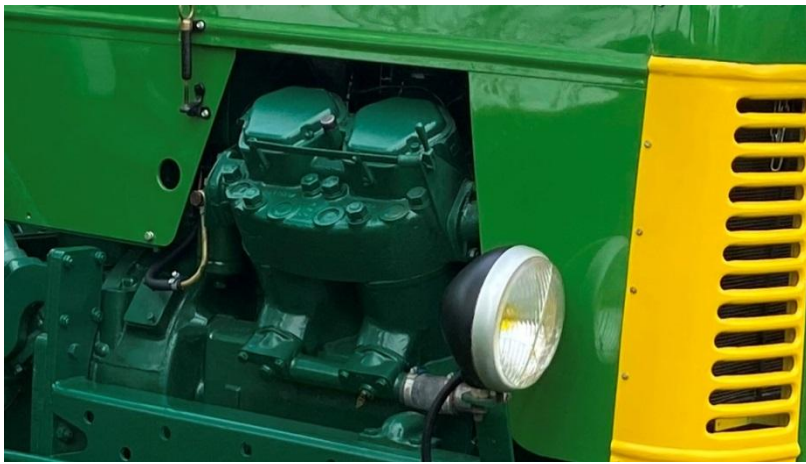
Aan elke kant zit een kleppenlichter (het hendeltje rechts naast de cilinderkop). In het pijpje midden tussen de cilinderkoppen wordt tijdens de koude start een kleine hoeveelheid dieselolie gegoten voor extra brandstof
