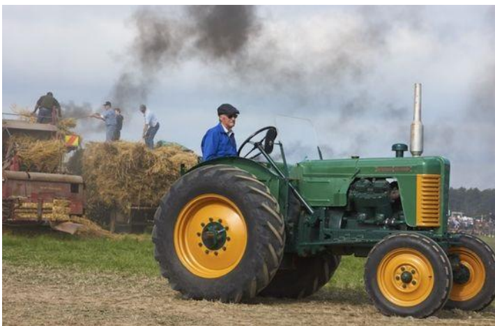
Vanaf de productie van de MK-2A zou het luchtfilter extern gemonteerd zijn Bij deze is het luchtfilter wel extern maar niet op de plaats van de latere uitvoeringen. Waarschijnlijk ook een MK-2.
