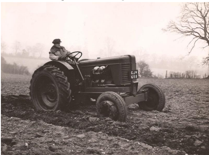
De prototypen van de Turner 4V-95 waren uitgevoerd met verschillende voorassen. Geen van deze prototypen zijn bewaard gebleven..
