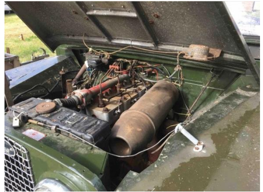
Turner L-60 motor geplaatst in een Landrover.
