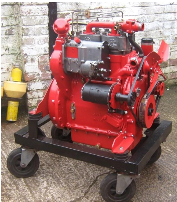
Beide omschreven tweetact 2 en 3 cilinder Turner dieselmotoren. Rechts de L-40 en links de L-60
