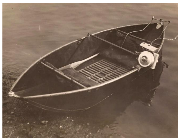
Sloep met een Turner Bray motor gemonteerd aan de zijkant van de boot
