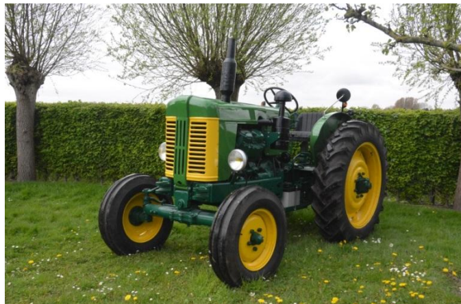
Turner Yeoman MK-3. Tijdens de productie van de MK-3 kregen de smalle spatborden een modernere vorm.
