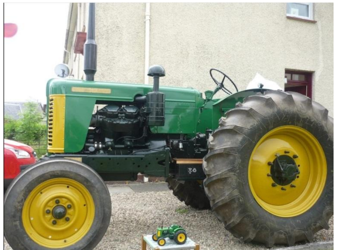
Turner Yeoman MK-2A of MK-2B, moeilijk te zeggen. De MK-2 had geen extern luchtfilter En de meeste MK-3 modellen hadden andere spatboren.
