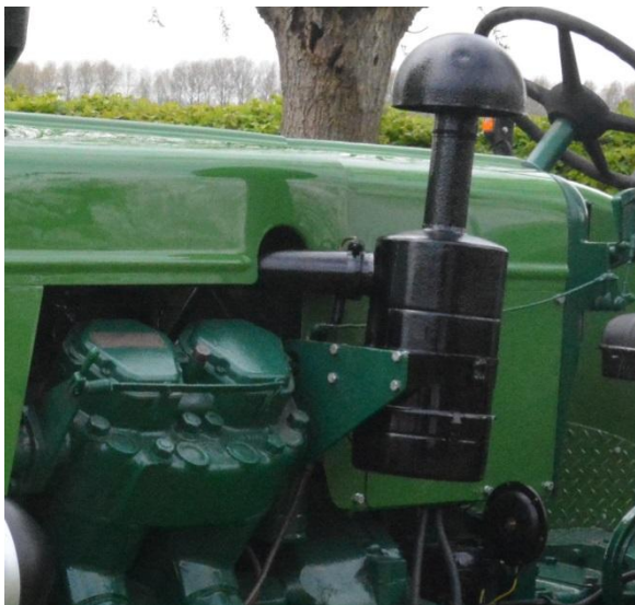
Tijdens de productieperiode van de MK-2A werd het luchtfilter onder de motorkap vervangen door een extern luchtfilter.
