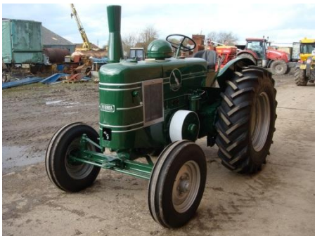
Bij de Serie III loopt de stuurstang voor de vooras en is in een H-profiel gegoten.
