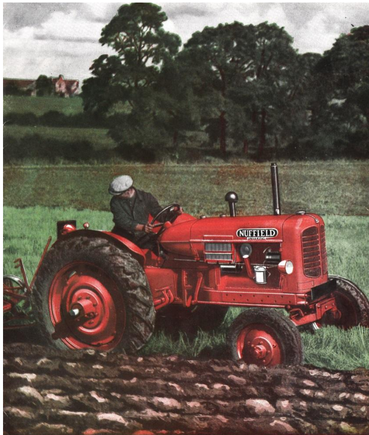
De spoorbreedte van de achterwielen zijn verstelbaar, door de wielen op de achteras te verschuiven naar de gewenste spoorbreedte.
