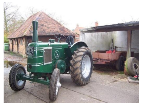
Zowel als bij de serie I als II loopt de stuurstang achter de vooras en bij de serie II steekt de achteras niet meer uit de velgen
