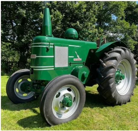
Bij de Serie I zijn de voorwielen gegoten en 5 gaats. Ook ontbreekt de cirkel rond de naam Field-Marshall
